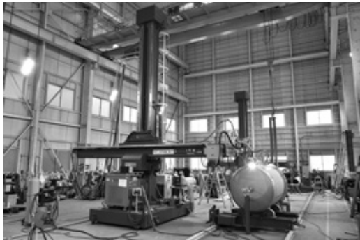
大型プラズマ溶接機で 自動化を進める
