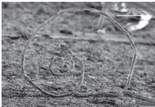
らせん状に発生した亜鉛のウイスカ (電子顕微鏡像)
