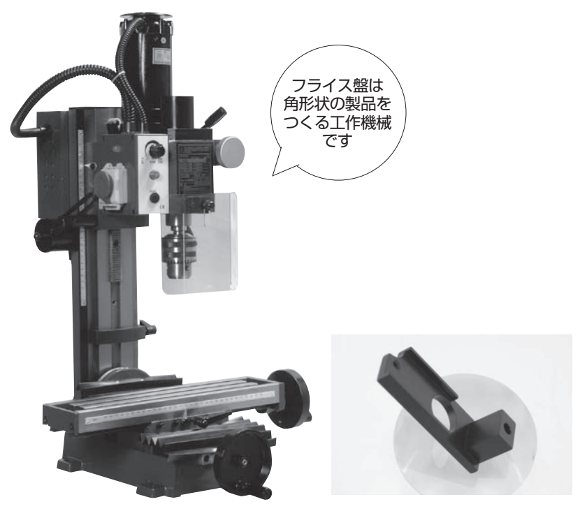
図1.4 ミニフライス盤(左)(写真提供:東洋アソシエイツ)と製品例(右)(写真提供:真下製作所)
