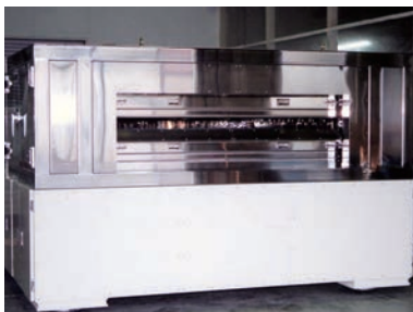
液晶用多段式硬化炉
