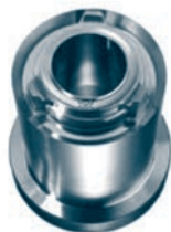
内径をジグ研削仕上。 真円度0.5μm
