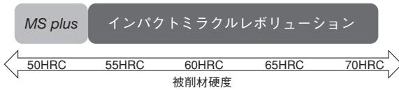
図4 被削材硬度によるコーティングの使い分け
